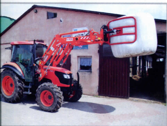
Wysoka wydajność hydrauliki pozwala na sprawne manewrowanie obciążonym ładowaczem na obrotach jałowych
