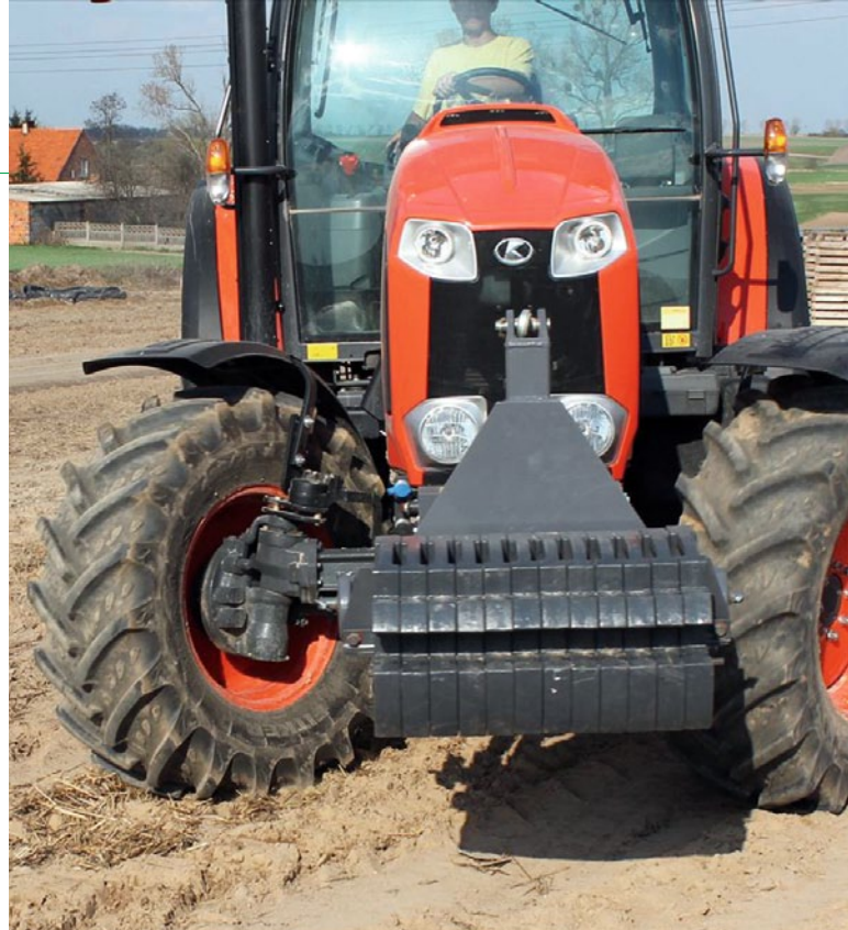
Ciągnik z załączonym systemem Be-Speed Turn robi po polu błyskawiczne kółka, których promień nie przekracza 4,5 m
