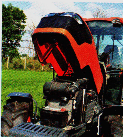
Unoszona maska zapewnia dobry dostęp do chłodnic i filtra powietrza.
