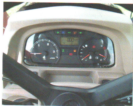
Połączenie tradycyjnych wskaźników zegarowych z wyświetlaczem elektronicznym sprawia, że wskazania są czytelne i dokładne.
