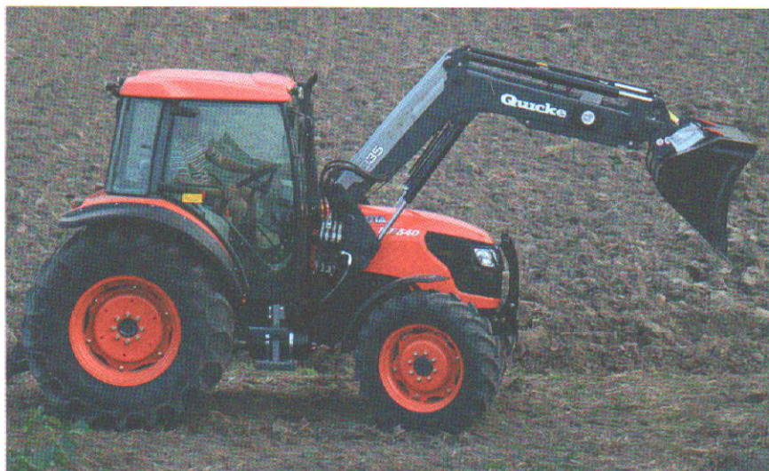
Zwarła budowa, rewers hydrauliczny oraz bardzo dobry skręt to atuty nowej Kuboty w pracy z ładowaczem.
