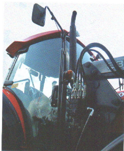
Dobłą widoczność zapewnia duża przednia szyba i tłumik poprowadzony wzdłuż prawego słupka kabiny.
