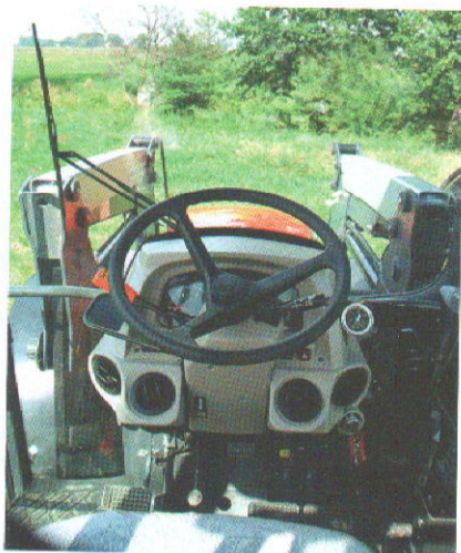
Dobłą widoczność zapewnia duża przednia szyba i tłumik poprowadzony wzdłuż prawego słupka kabiny.
