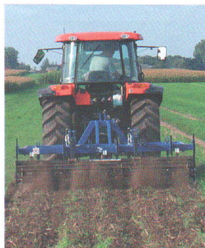
Na glebach średniozwięzłych 88-konna Kubota M8540 to rozwiązanie idealne do pracy z pługiem czteroskibowym, ale do kultywatora ścierniskowego o szerokości 2,6 m jest za słaba.
