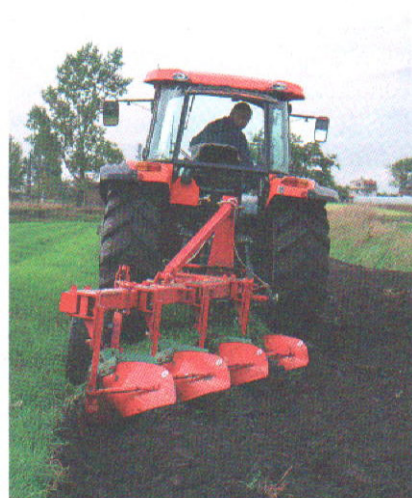
Na glebach średniozwięzłych 88-konna Kubota M8540 to rozwiązanie idealne do pracy z pługiem czteroskibowym, ale do kultywatora ścierniskowego o szerokości 2,6 m jest za słaba.
