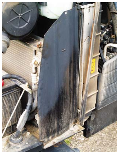
Aby uzyskać dostęp do pakietu chłodnic, np. w celu oczyszczenia lub konserwacji, wystarczy otworzyć niewielką osłonę.
