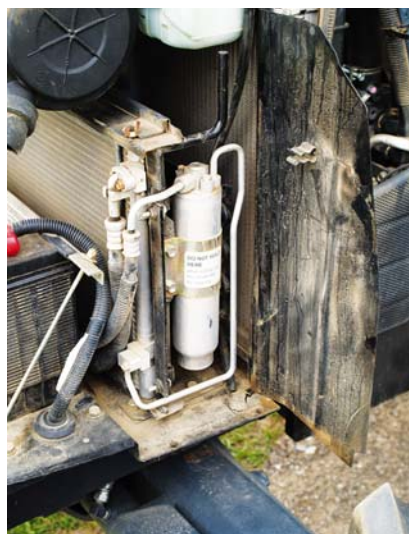
Aby uzyskać dostęp do pakietu chłodnic, np. w celu oczyszczenia lub konserwacji, wystarczy otworzyć niewielką osłonę.
