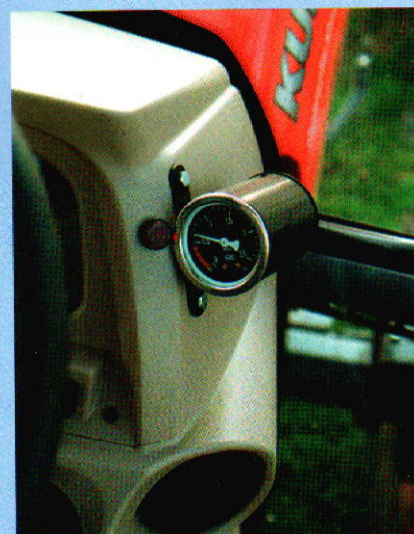
Zbiornik powietrza instalacji znajduje się po prawej stronie kabiny, z boku kolumny kierowniczej trochę na siłę wciśnięty jest wskaźnik ciśnienia układu pneumatycznego.
