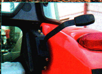
Do sprawnej obsługi podnośnika z zewnątrz potrzeba trochę wprawy, ale po opanowaniu tej czynności, wszystko działa poprawnie.
