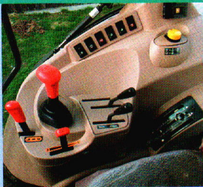
Prosty i przestronny panel sterowania m.in. przekładnią, podnośnikiem i WOM-em, ułatwia obsługę tych sekcji.
