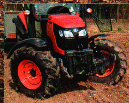
Ogromna zaleta „japończyka” to bardzo duża zwinność – promień skrętu to niecałe 3,5 m.
