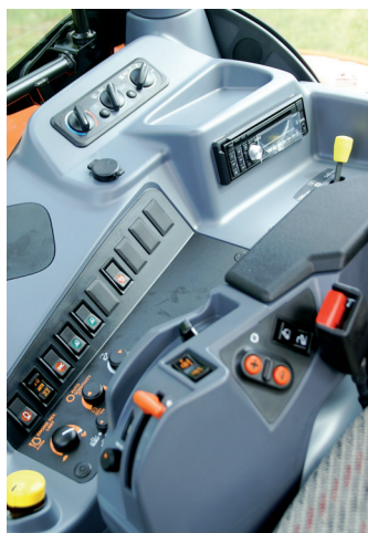
Rozbudowana prawa część kabiny stanowi centrum sterowania m.in. podnośnikiem, czułością reakcji skrzyni biegów oraz trybem pracy amortyzowanej osi.
