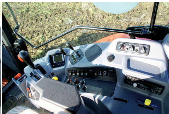
Rozbudowana prawa część kabiny stanowi centrum sterowania m.in. podnośnikiem, czułością reakcji skrzyni biegów oraz trybem pracy amortyzowanej osi.
