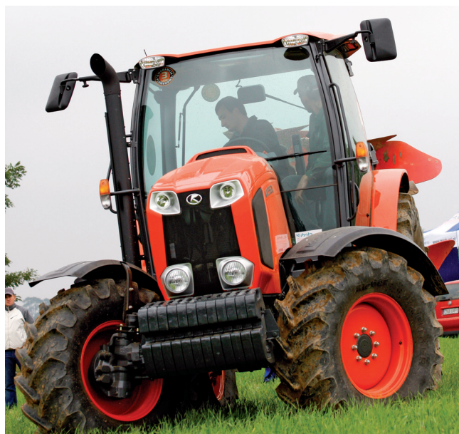
Bi-Speed Turn to rozwiązanie pozwalające na szybki i wąski nawrót. Funkcja włączająca się przy pełnym skręcie kół przydaje się na końcu pola.
