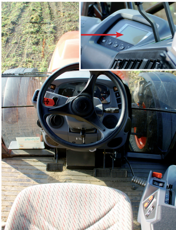
Prosta deska i zwykle, analogowe zegary w zupełności wystarczają do pracy i przekazywania operatorowi najważniejszych informacji. Po prawej stronie znajduje się wyświetlacz cyfrowy pokazujący m.in. aktualne zużycie paliwa.
