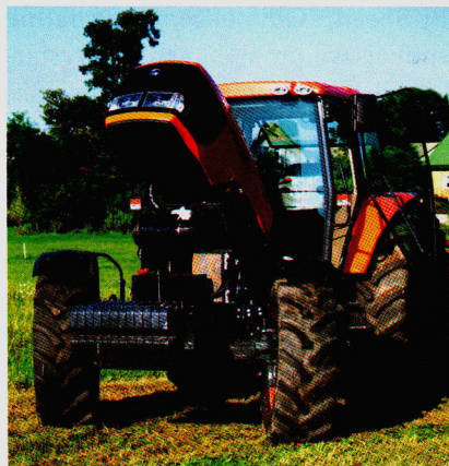
Pod maską ciągnika pracuje „niewyżyfowany” 4-cylindrowiec Kuboty o pojemności 6 l. Dostęp do punktów obsługowych jest dobry.
