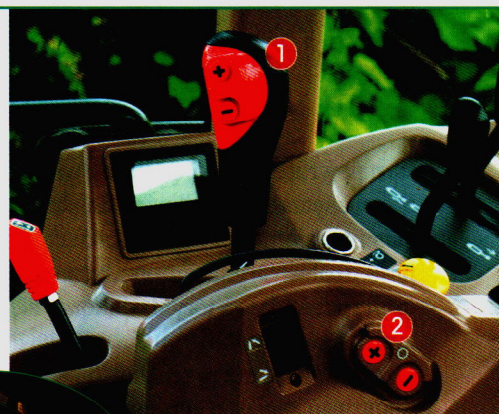
Przekładnia Intelli-Shift oferuje 16 biegów (po 8 w dwóch grupach) przełączanych pod obciążeniem przyciskami „+” i „-” umieszczonymi na dźwigni (1) i na podłokietniku (2). Rewers elektrohydrauliczny znajduje się pod kierownicą.
