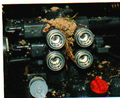
Złączom hydraulicznym przydałyby się tzw. antywycieki i lepsza ochrona przed błotem, które wydostaje się spod kół.
