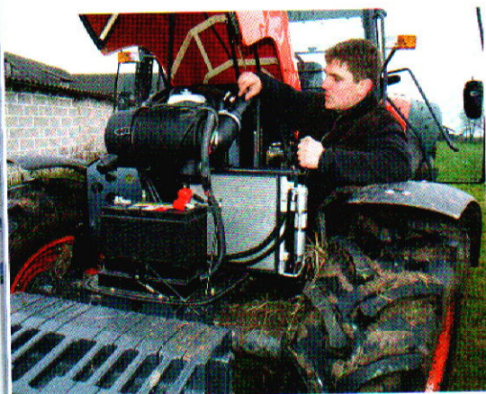
Dostęp do wysuwanych chłodnic, tak jak do filtra powietrza, jest bardzo łatwy.
