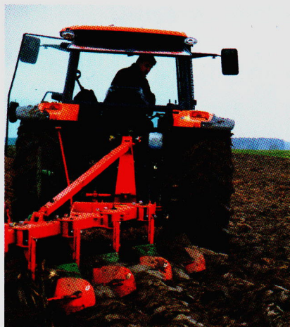
W czasie testu, zużycie paliwa oceniliśmy na 8,7 l/h. Jak na ciągnik tej mocy – w normie.
